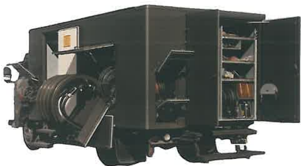
Ett automatiskt testsystem på hjul för test av AJ 37 Viggen. Första leverans 1969.
