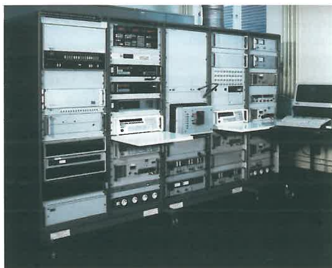
ATS11 för test av hybridkort.
