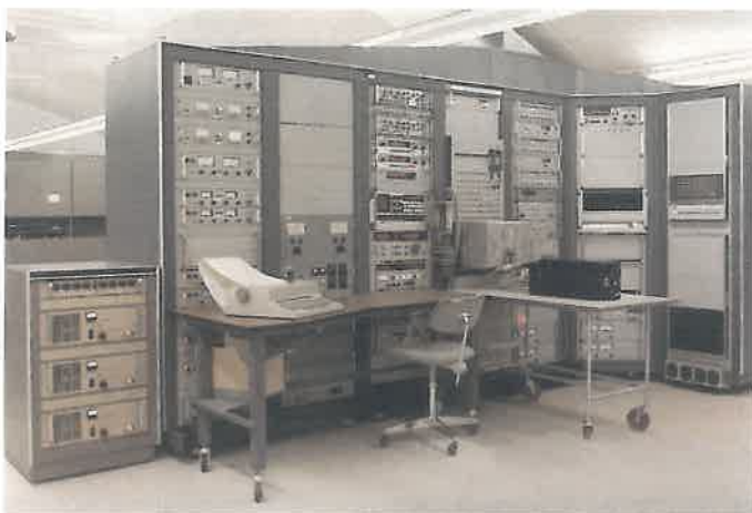
ATS1 (ovan) och ATS10 (nedan) för test av elektronikenheter upp till 400 MHz. Första leverans 1971.
