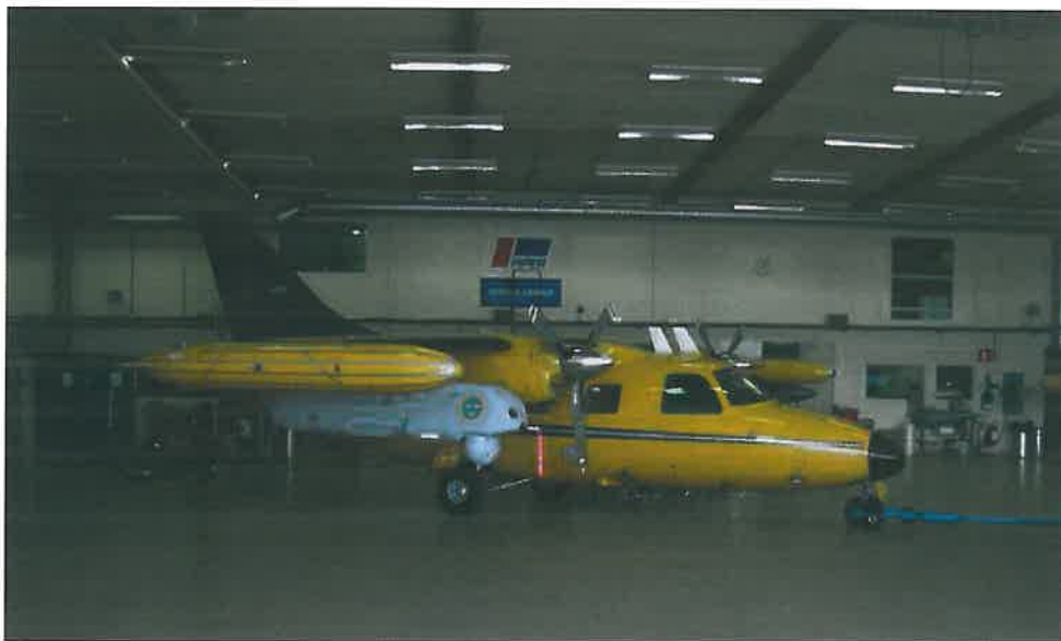
Kapseln monterad under vingen på Saab Nyge Aeros MU-2.
