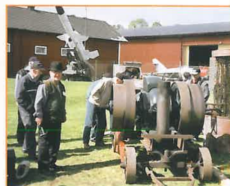
Motordagens största motor. En 35 hk Beijer motor, vikt 2 800 kg. Denna typ av motor har ofta använts i sågverk, stenkrossar mm. Foto: Ingemar Lindstrand, Malmslätt.
