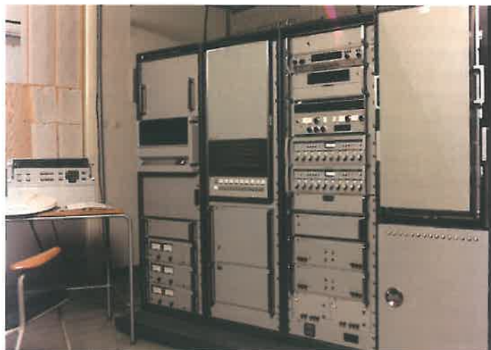
Ett automatiskt testsystem på hjul för test av AJ 37 Viggen. Första leverans 1969.
