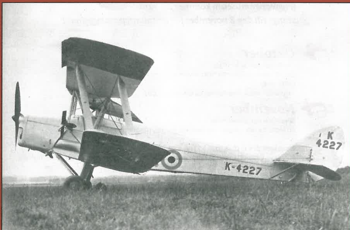
Landversionen av Queen Bee. Lägga märke till den vinddrivna kompressorn och den täckta bakre sittbrunnen.
