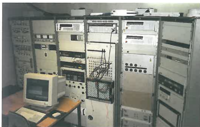
ATS1 (ovan) och ATS10 (nedan) för test av elektronikenheter upp till 400 MHz. Första leverans 1971.
