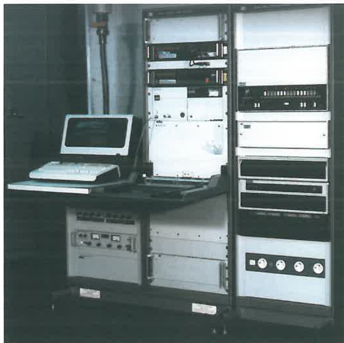
ATS6 för test av digitala kretskort.
