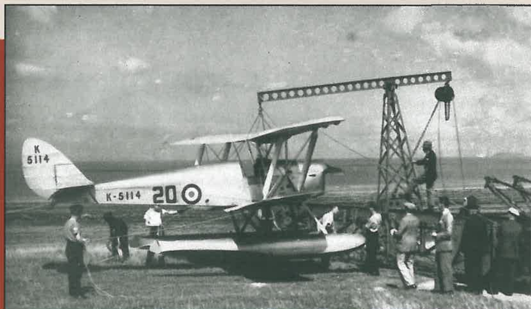
Sjöversionen av Queen Bee. Planet håller på att monteras på en landbaserad katapult vid Thorney Island i södra England.
