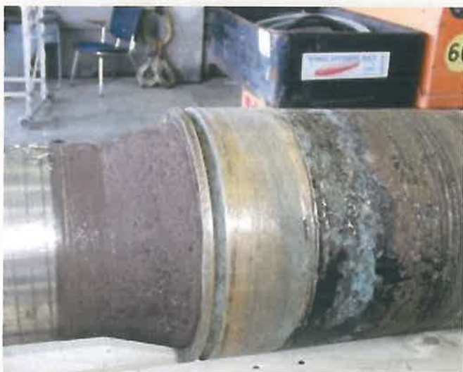
Detalj av korrosions- och nötningskada.
