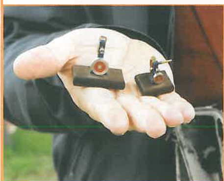
Motordagens minsta motorer, Leif Åhmans ångmaskiner med en kolvdiameter på 3 mm. Foto: Foto Malmen AB.
